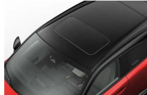
Toit ouvrant à commande électrique
